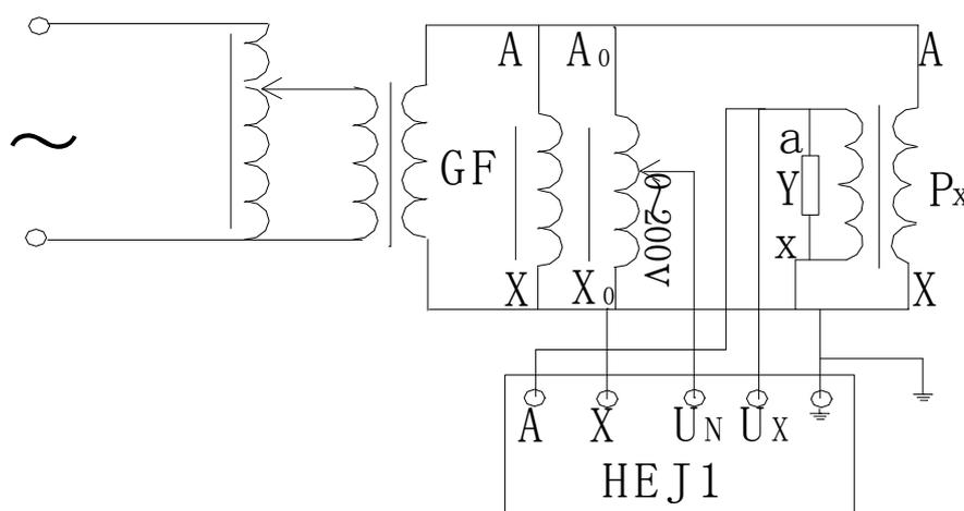
使用感应分压器校验电压互感器时，按上图连线，一般感应分压器相对被检电压互感器准确度而言，标准的误差可以忽略不计，从电压互感器校验仪上
