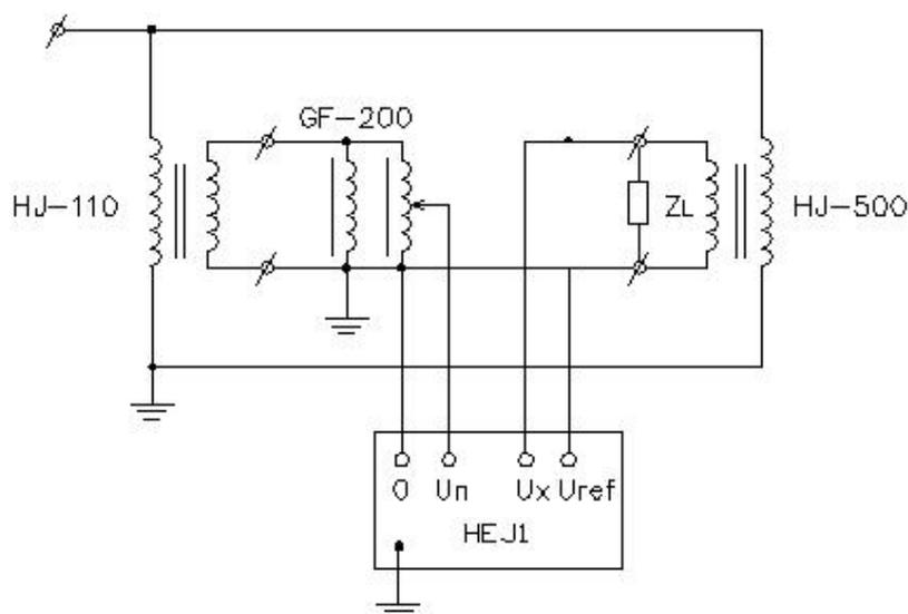
如果标准电压互感器与被试电压互感器额定变比不同时，可以用标准电压互感器与感应分压器级联，测出被检电压互感器的误差。
