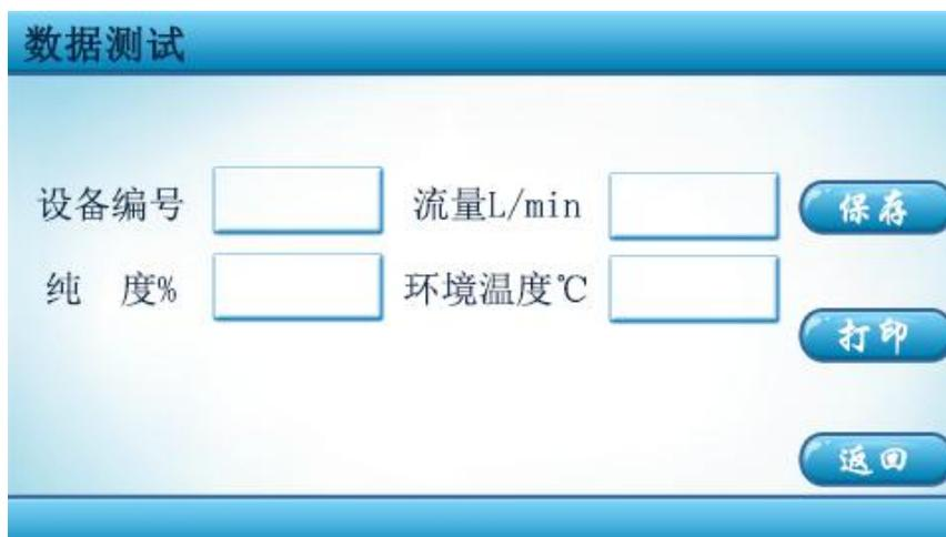
设备测量数据稳定后，按“保存”键可以将数据保存下来，按“打印”，可以将当前测试的数据打印出来，保存和打印之前可以点击屏幕设备编号位置来设置设备编号。
